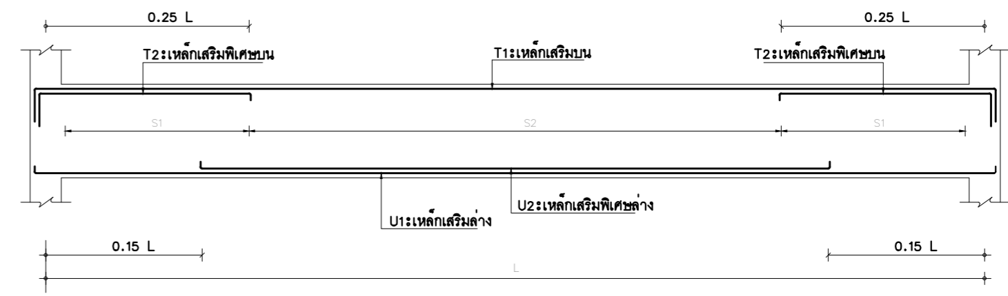
แบบขยายการเสริมเหล็กคานช่วงเดียวมาตรฐานทั่วไป
